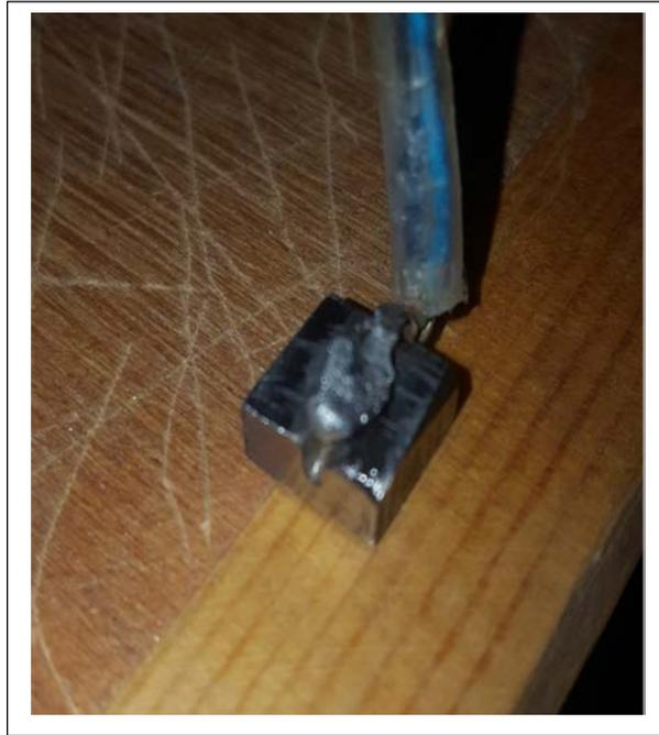
**Figure II.2 :** Soudure du fil électrique.
