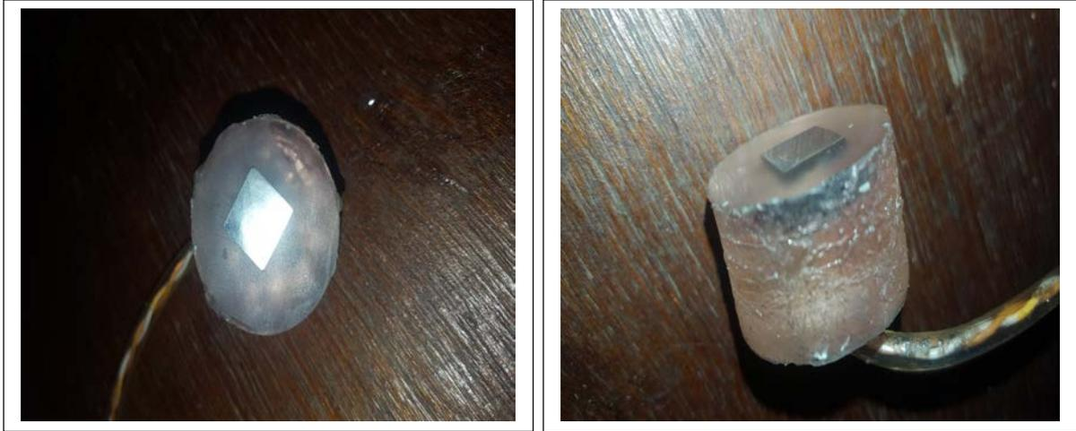
**Figure II.3** : Enrobage des échantillons.
