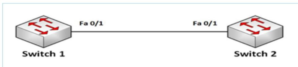
Figure 2-11 : Schéma illustre l'interconnexion de deux switch sans Etherchannel [30].
