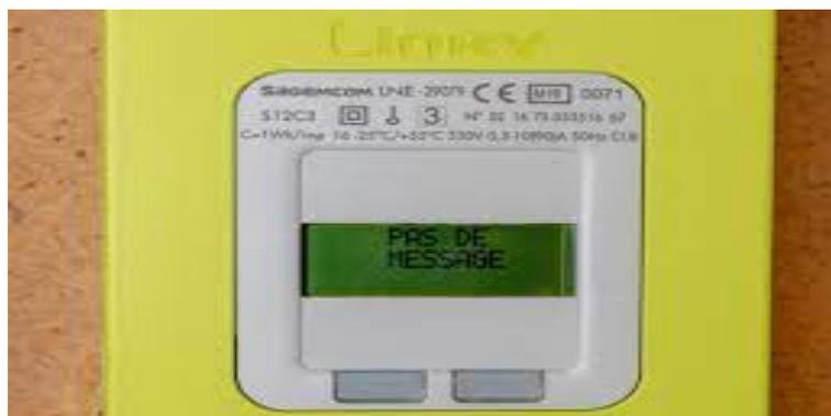
Figure 2.5: illustration d'un compteur Edf Linky
