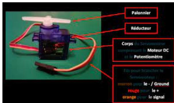
Figure 3.4: image montrant un servomoteur
