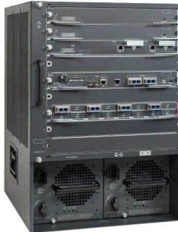
FIG. 2.5 : Commutateur Catalyst Cisco 6509.
