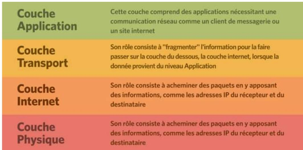
FIG. 1.3 : Le modèle TCP/IP.
