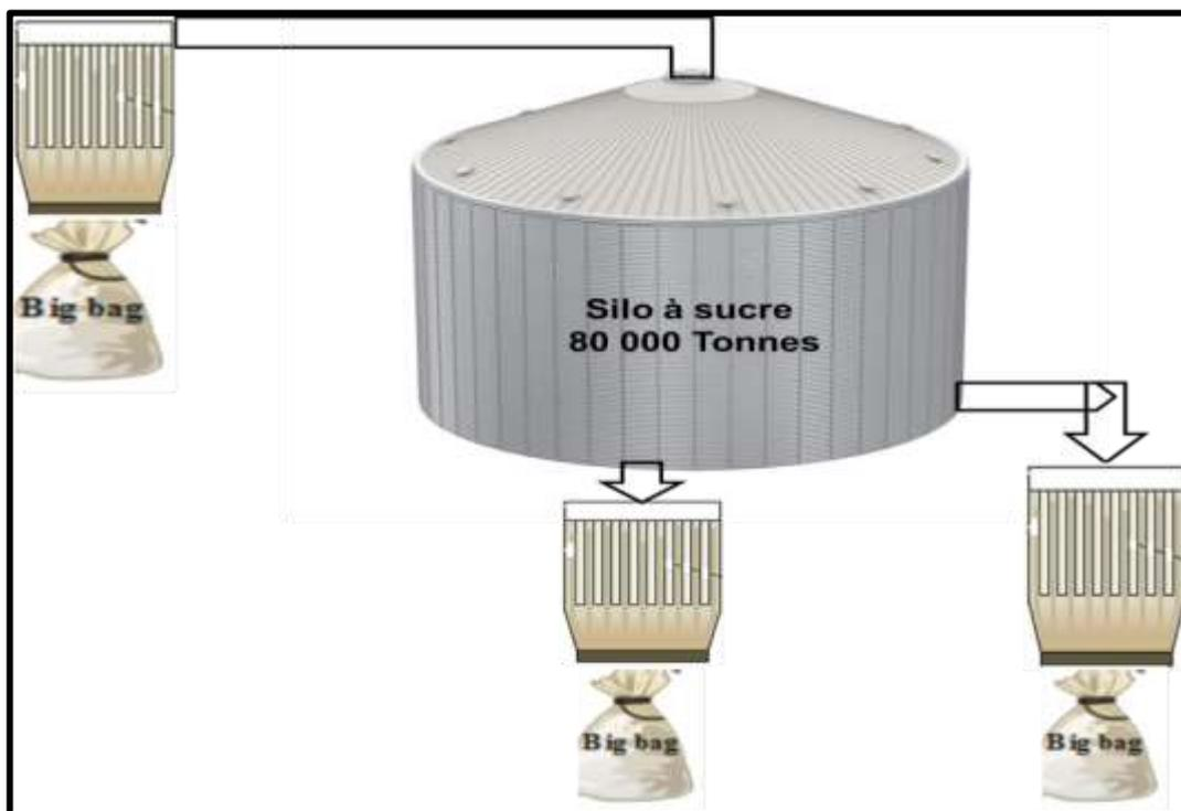
Figure II.8. Schéma simplifié du système de dépoussiérage au niveau du silo à sucre de CEVITAL
