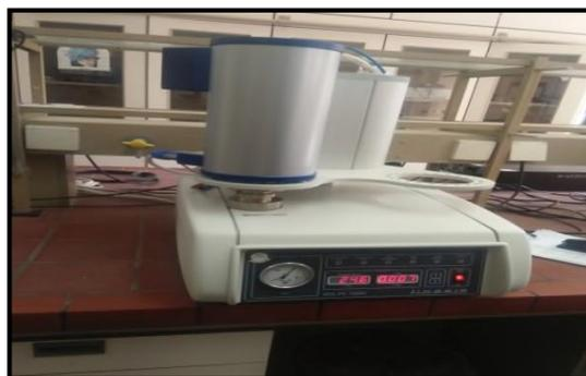
**Figure II.7 :** L'appareil d'analyse ATG/DTG.
