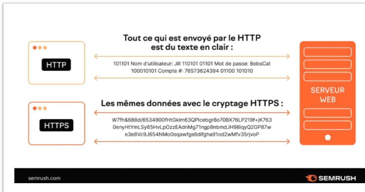
**Figure 1.13:** à comparaison entre HTTP et HTTPS. [25]
