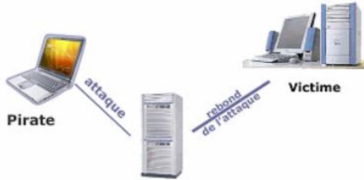
**Figure 1.8:** Attaque par rebond
