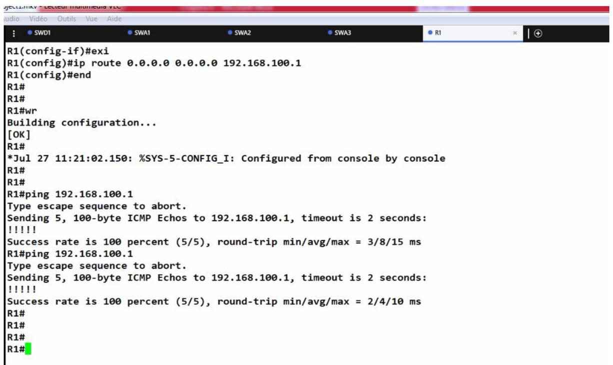
Figure 3.30: vérification la connectivité de R1 vers firewall
