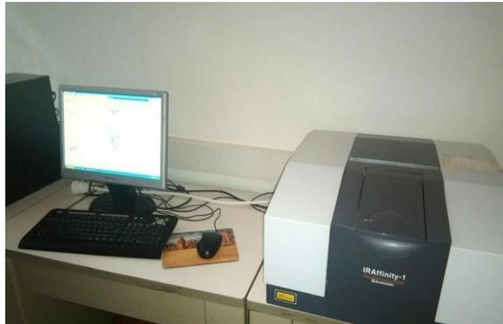
**Figure III. 6:** Photo du spectrophotomètre infrarouge
