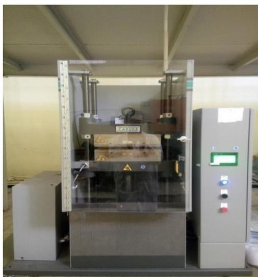
**Figure III. 3 :** Photo d'une presse hydraulique utilisée pour la préparation des plaques
