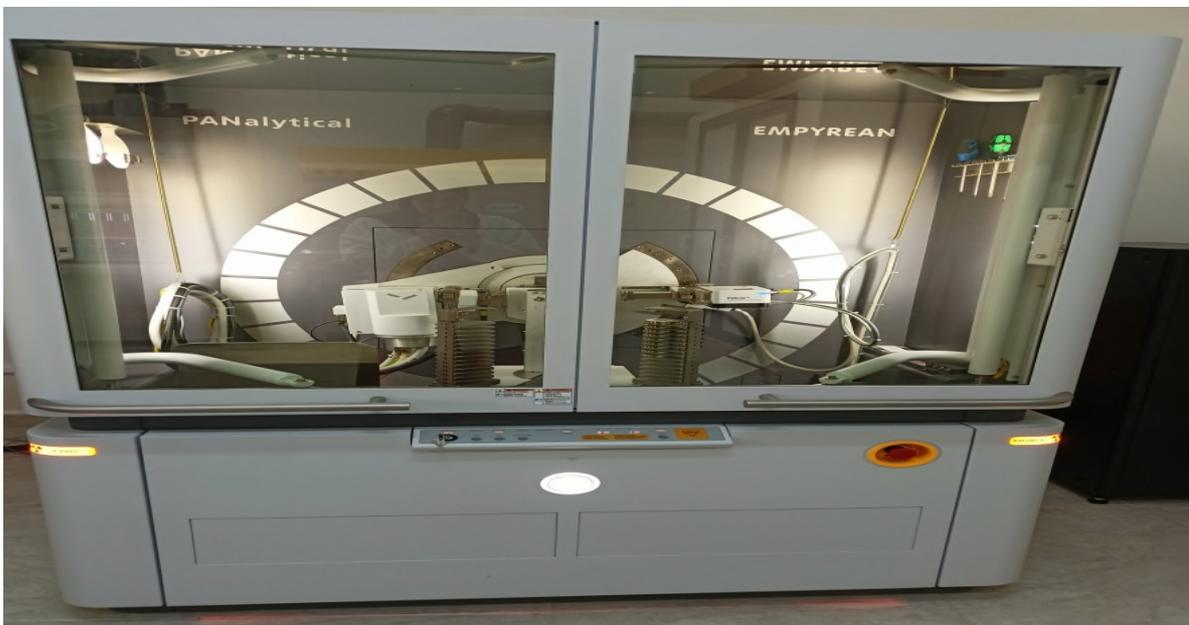
Figure IV.7 : Photographie de la machine de DRX.
