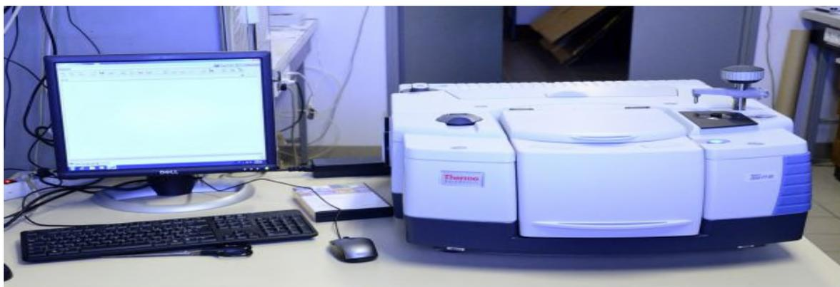
**Figure IV.6 :** Spectromètre infrarouge à transformée de Fourier.
