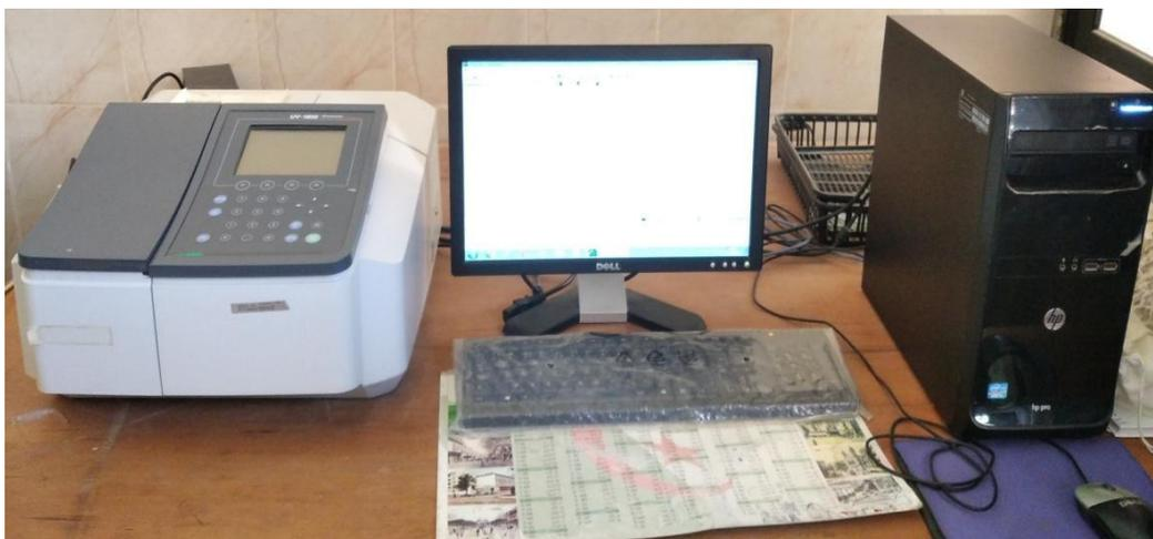
**Figure II.2.** Le spectrophotomètre UV-Visible utilisé pour mesurer les absorbances des solutions préparées.
