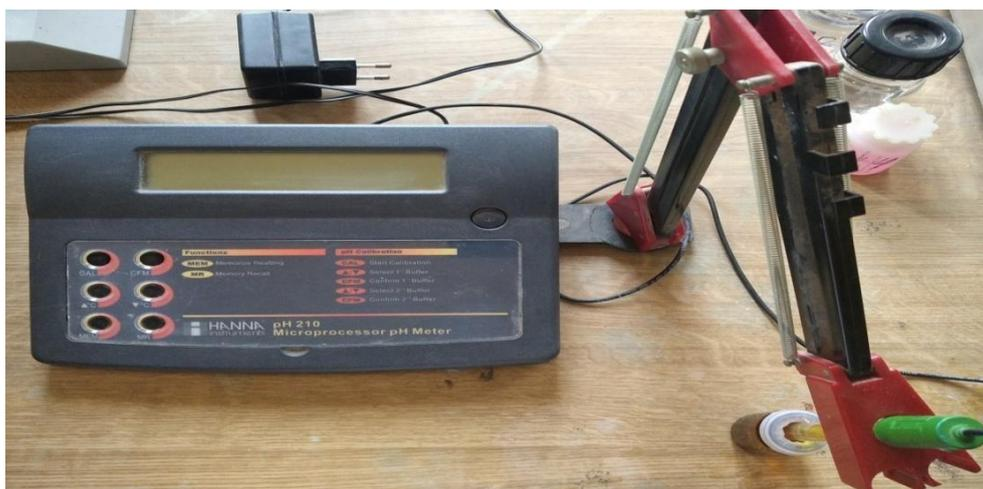
Figure II.1. Le pH mètre utilisé.
