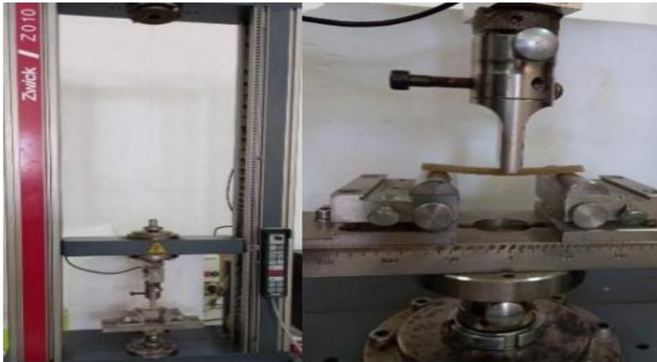
**Figure 27** : Machine de flexion.
