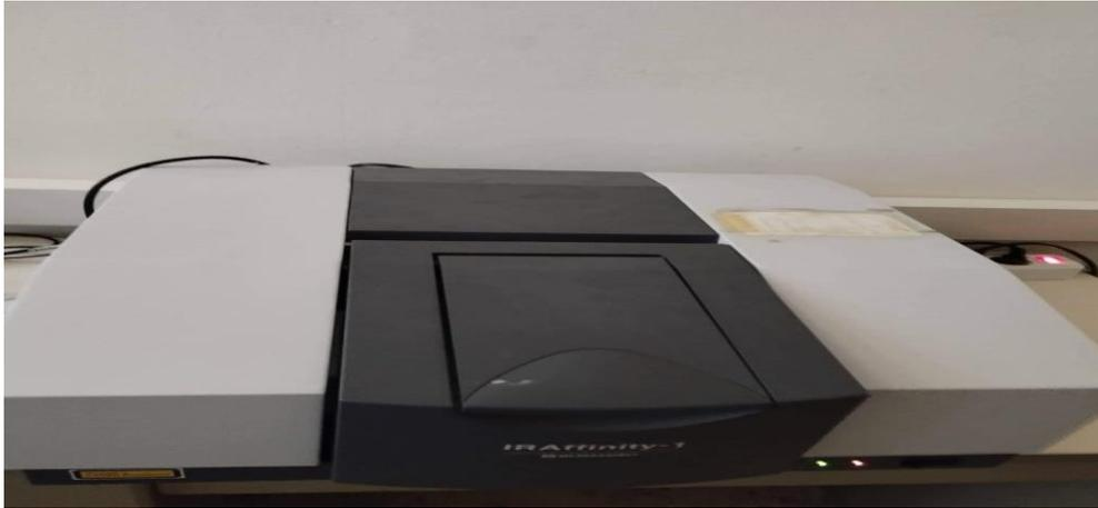
Figure 24 : Spectromètre IRTF
