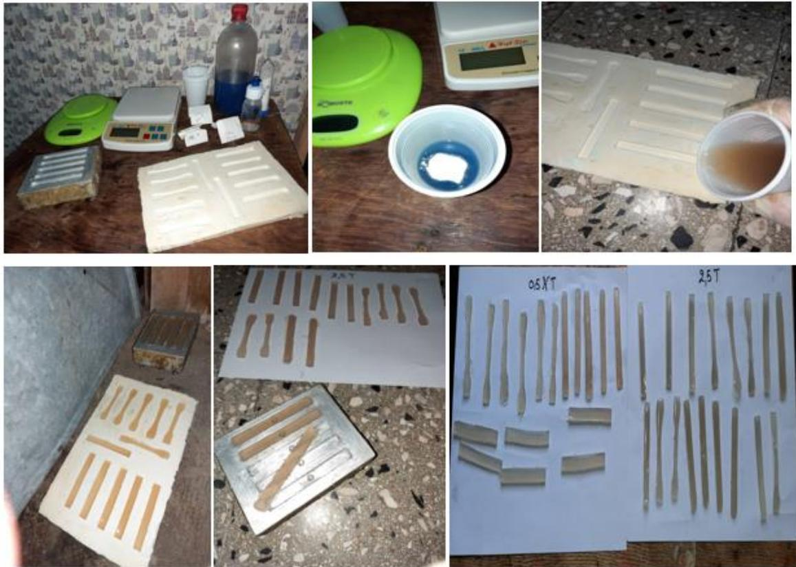
**Figure 20 :** Elaboration et préparation des éprouvettes des différentes formulations UP et UP/CMCT et UP/CMCNT
