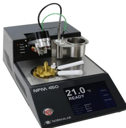
**Fig.V.6** : Appareil de détermination de point d'éclair
