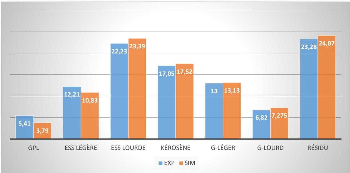
**Fig.VII.16** : Histogramme des résultats de la simulation et de l'expérimental des rendements en volume des coupes pour le brut 2
