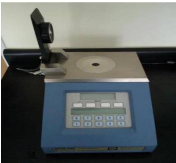
**Fig.V.7** : Appareil de détermination de l'indice de réfraction « Réfractomètre »
