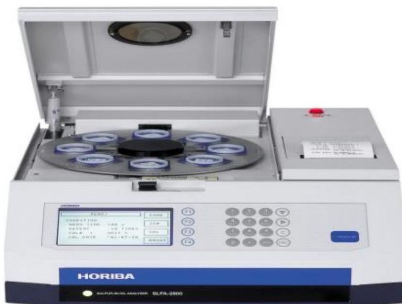
Fig.V.9 : Appareil de détermination de la teneur en soufre par fluorescence rayon X
