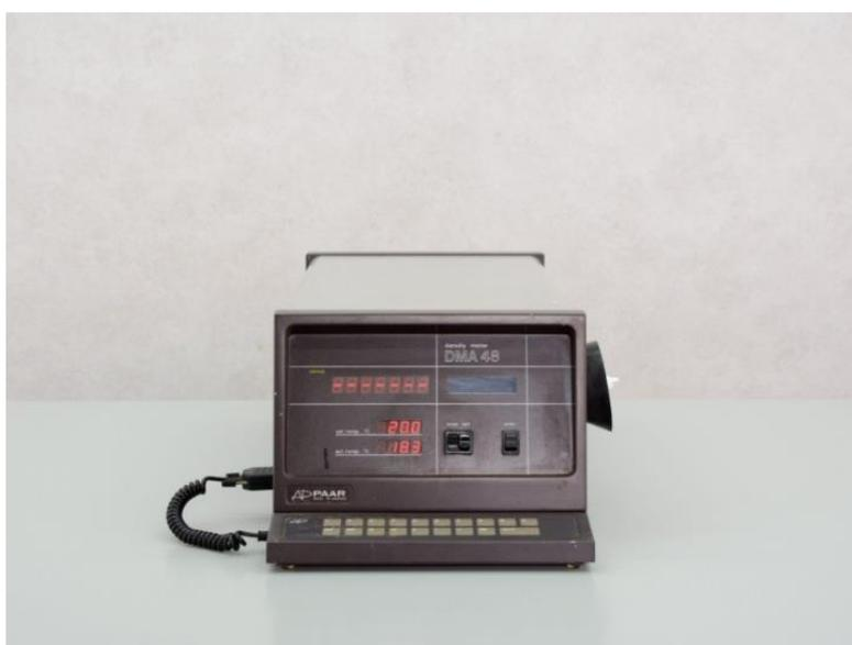
**Fig.V.4** : Densimètre électrique à tube en U oscillant
