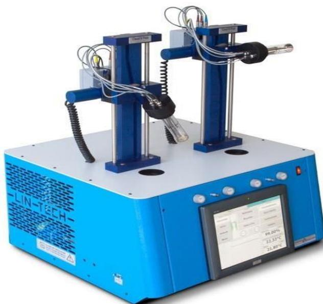
**Fig.V.11** : Appareil de détermination de point de congélation et point de trouble
