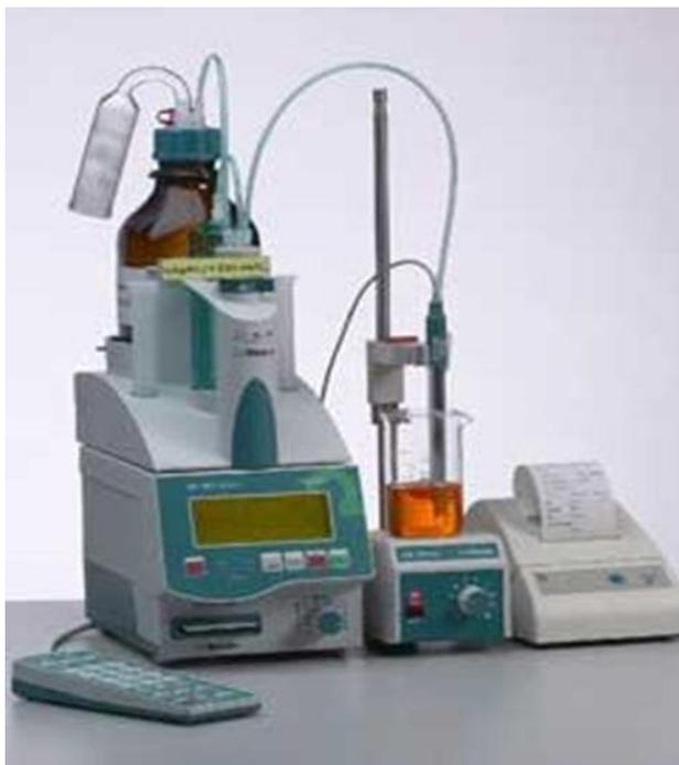
**Fig.V.12** : Appareil pour détermination de l'indice d'acidité
