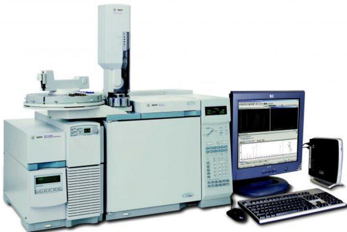
**Fig.V.3** : Chromatographe en phase gazeuse
