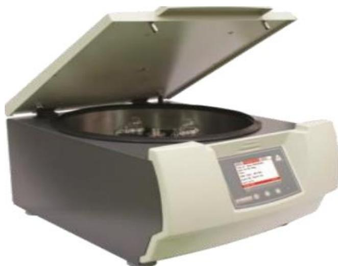
**Fig.V.8 :** Appareil de détermination de la Teneur en eau et sédiments (BSW)
