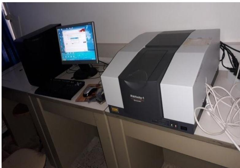
**Figure II.6** : Spectrophotomètre IRTF
