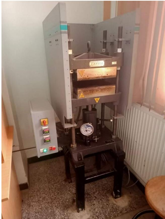
**Figure II.4** : presse Hydraulique manuelle
