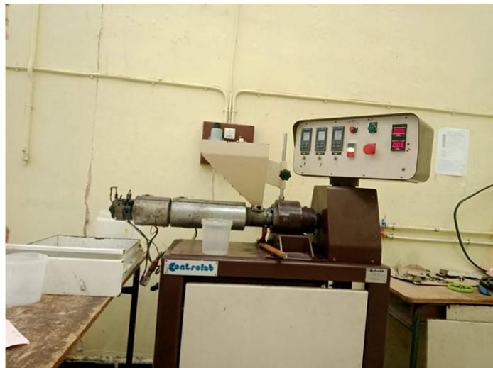
**Figure II.3** : extrudeuse mono-vis
