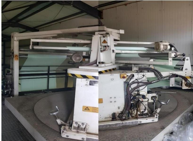
**Figure 19 :** Système de réversion à plateau tournant.
