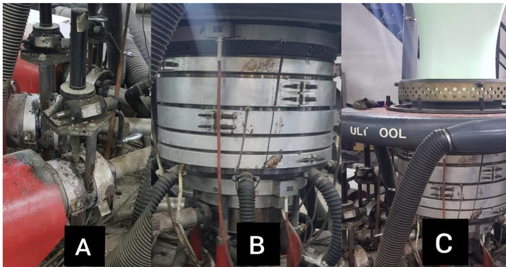
**Figure 18 :** (A) Grille de contrepression et filtre, (B) Filière, (C) un anneau de refroidissement.
