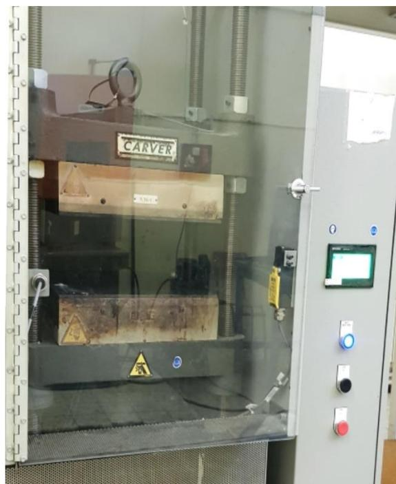
**Figure 21** : Presse hydraulique à deux plateaux chauffants.
