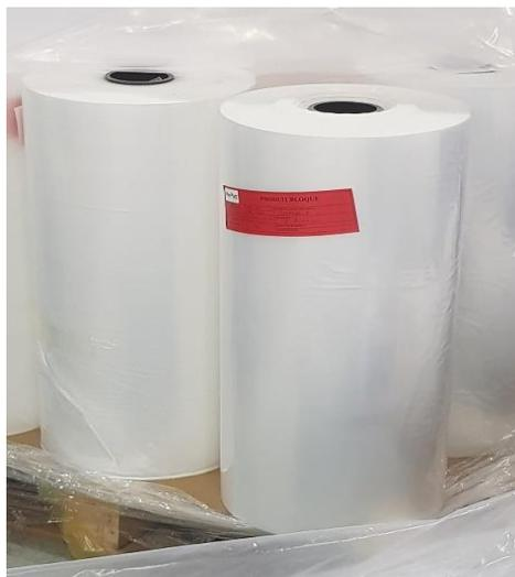
**Figure 20 :** Bobine de film tri-couche.
