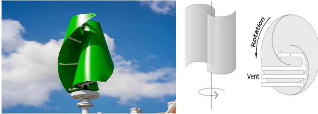
**Figure. I.9** : Eoliennes des types SAVONIUS [17].
