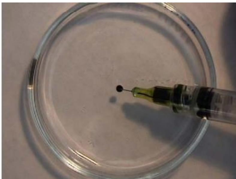
**FIGURE II. 10 :** versement d'une goutte visqueuse sur un liquide
