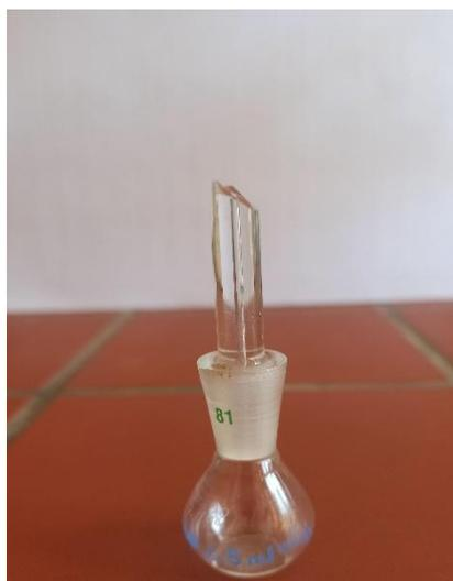
**Figure 30 :** Pycnomètre
