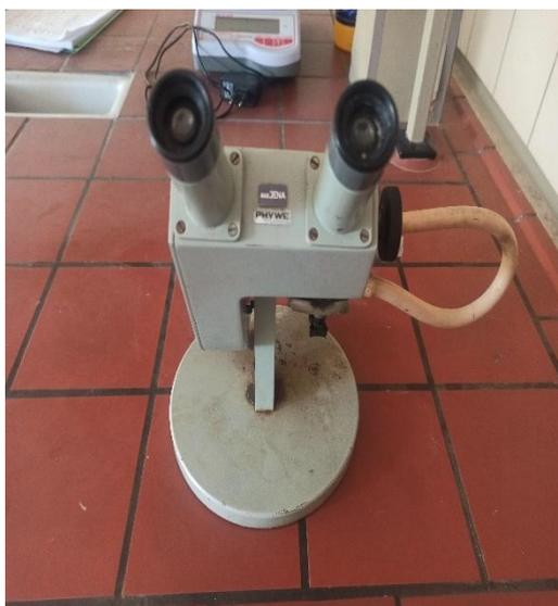
**Figure 31** : Réfractomètre
