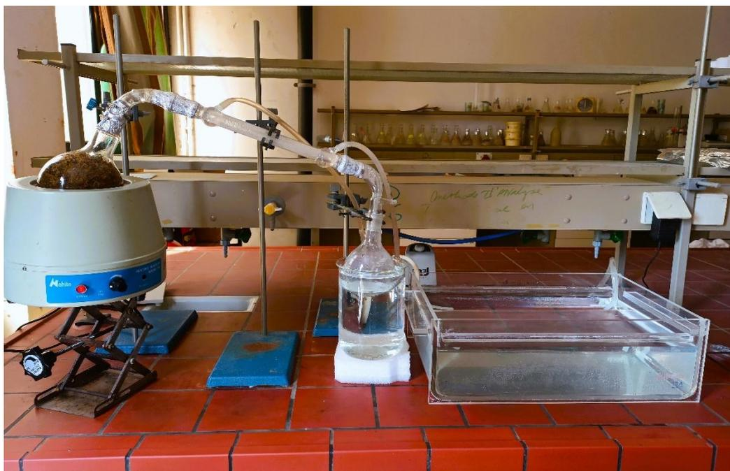
**Figure 26 :** Dispositif de l'hydrodistillation
