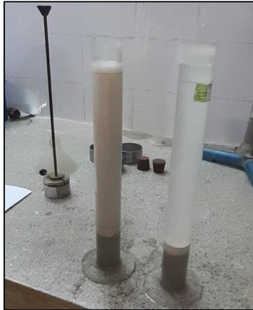
**Figure II.3 :** Mesure de la hauteur du sable mélange.
