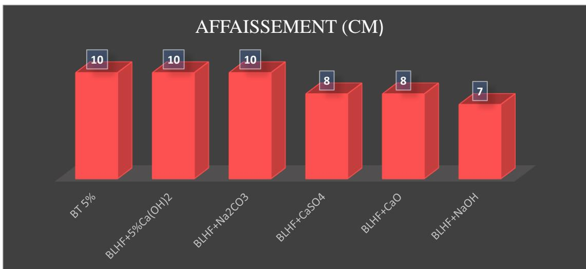
**Figure IV.12** : Affaissement des bétons au LHF activé.
