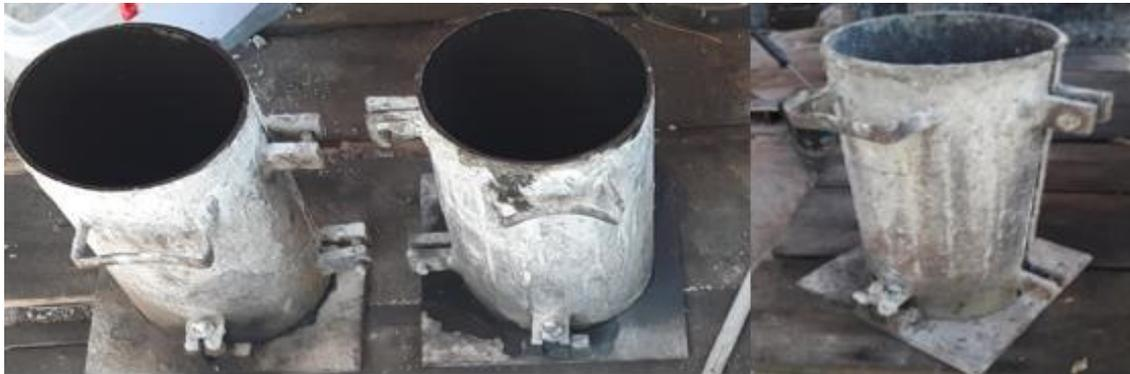
**Figure III.4 :** les moules cylindriques  $16 \times 32 \text{ cm}^2$ .
