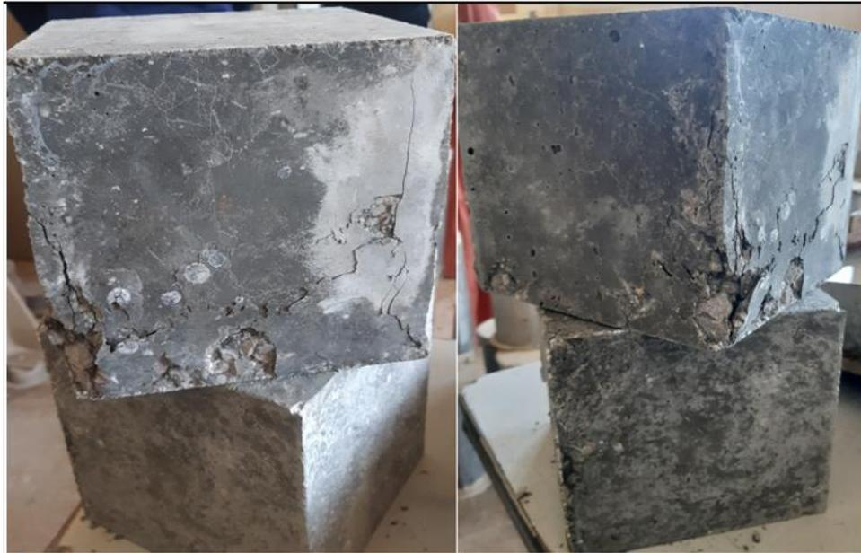
Figure IV.9 : Eprouvettes du béton au LHF après écrasement.
