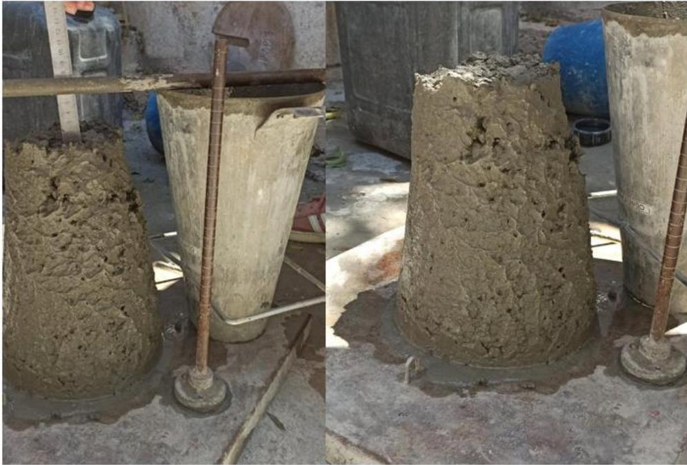
**Figure IV.11** : Affaissement au cône d'Abrams du béton au laitier activé.
