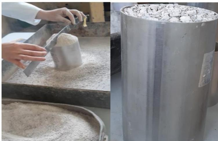
**Figure II.5** : Exemple de mesure des masses volumiques apparentes du sable 0/4 et du gravier 8/15.
