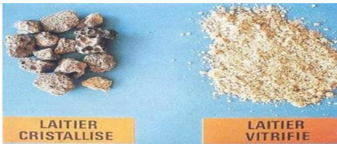
**Figure I.2** : Laitier cristallisé et vitrifié de haut fourneau.
