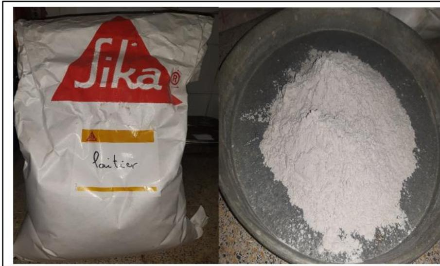
Figure II.7 : Laitier granulé broyé de haut fourneau.
