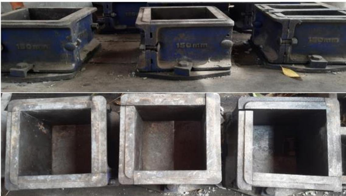
**Figure III. 5 :** les moules cubiques  $15 \times 15 \times 15 \text{ cm}^3$ .
