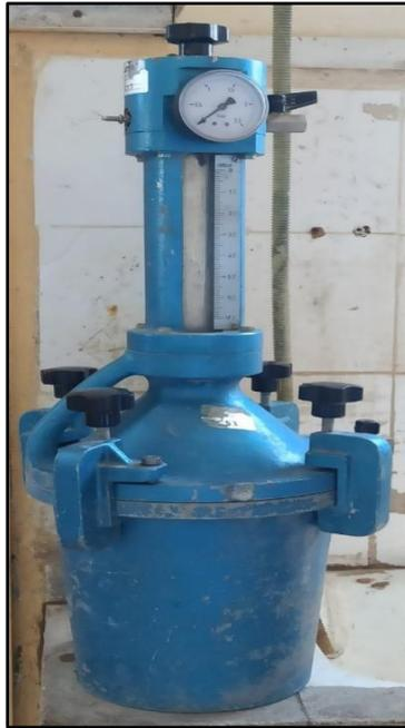
**Figure IV.3 :** Aéromètre à béton utilisé au laboratoire LTPEST.
