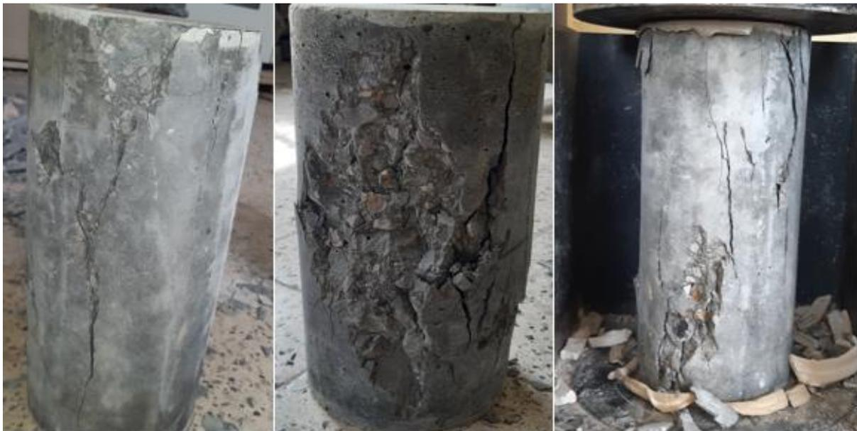
**Figure IV.17** : Eprouvettes du béton au LHF activé après écrasement à 90jours
