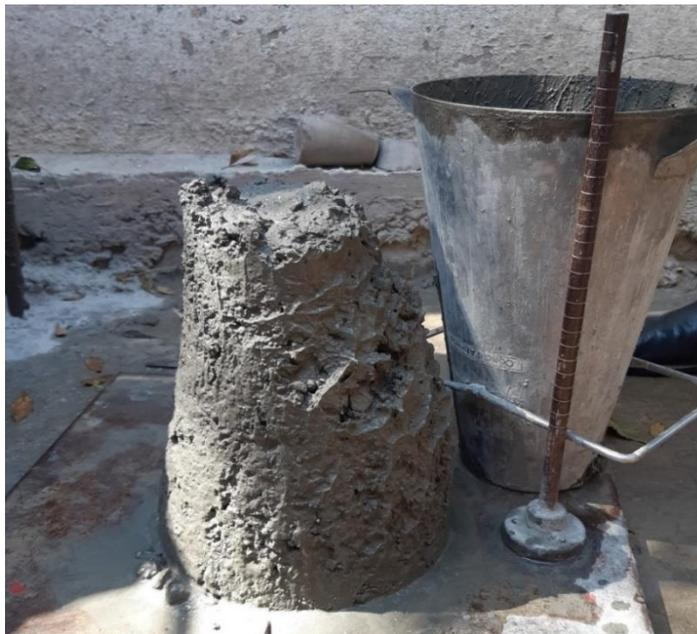
**Figure IV.1** : Affaissement au cône d'Abrams du béton au laitier
