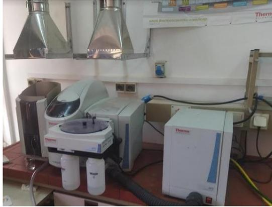
Figure 10: Spectrophotomètre d'Absorption Atomique (SAA).
