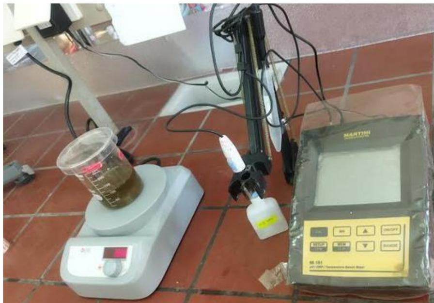
**Figure 12** : Montage du processus de biosorption
