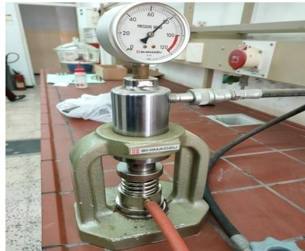
**Figure III.9 :** moules à pastilles utilisés **Figure III.10 :** presse de laboratoire pour Compression des poudres.
