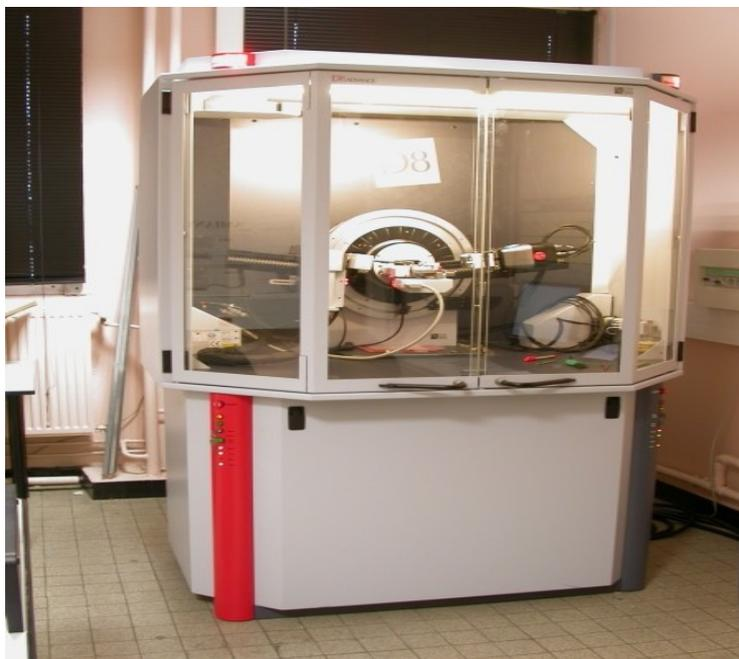
Figure II.17 : Diffractomètre sur poudre
