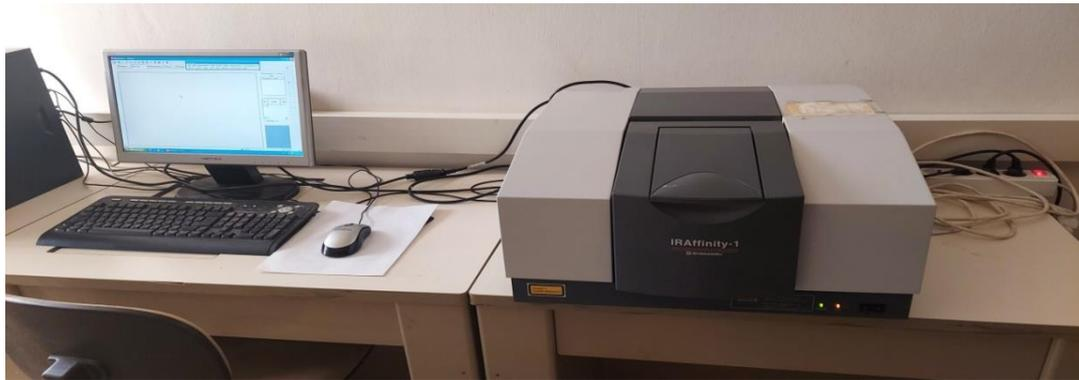
**Figure.III.8.** Spectrophotomètre à transformée de Fourier de type SHIMADZU FTIR-8400S.
