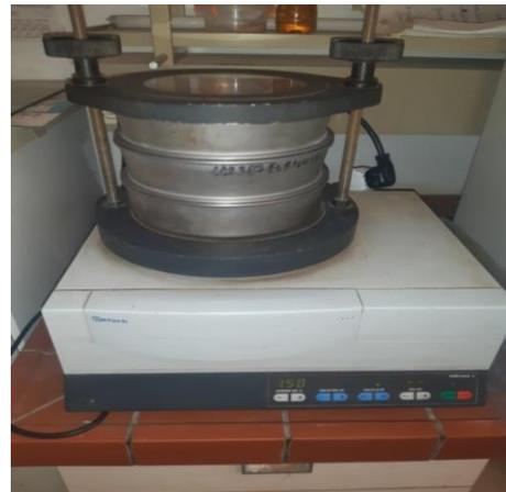
Figure. III.3. Appareil de tamisage.
