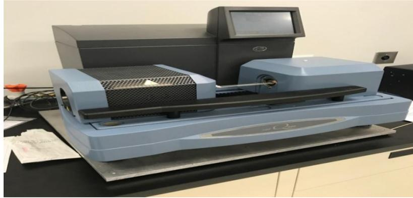
**Figure.III.9.** L'appareil thermogravimétrique de type SDT.Q600.V20.9.Build.20.
