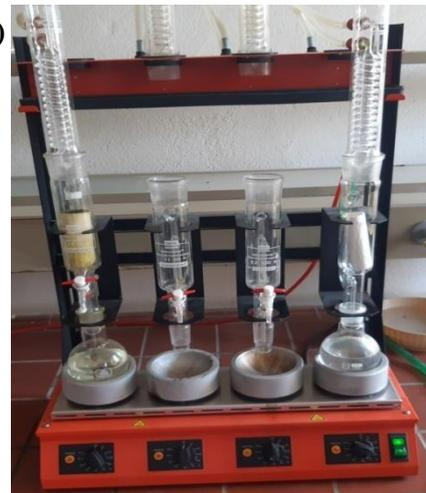
Figure. III.4. L'appareil de Soxhlet.
