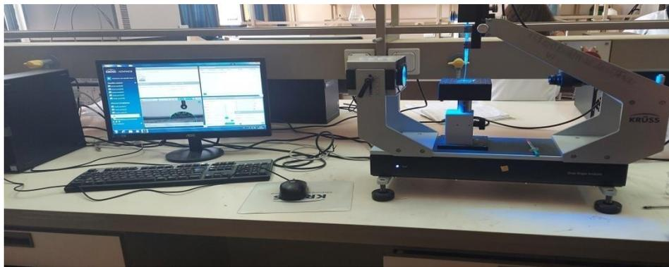
**Figure.III.10.** L'appareil de mesure d'angle de contact
