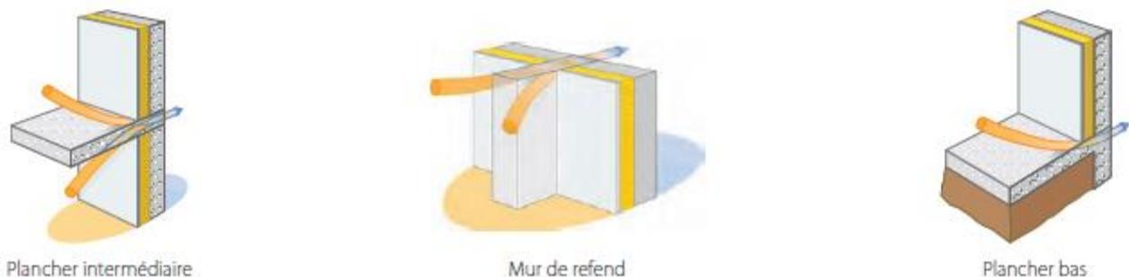
Figure 1.6 : Ponts thermiques des liaisons (Source : Saint-Gobain, 2012)
