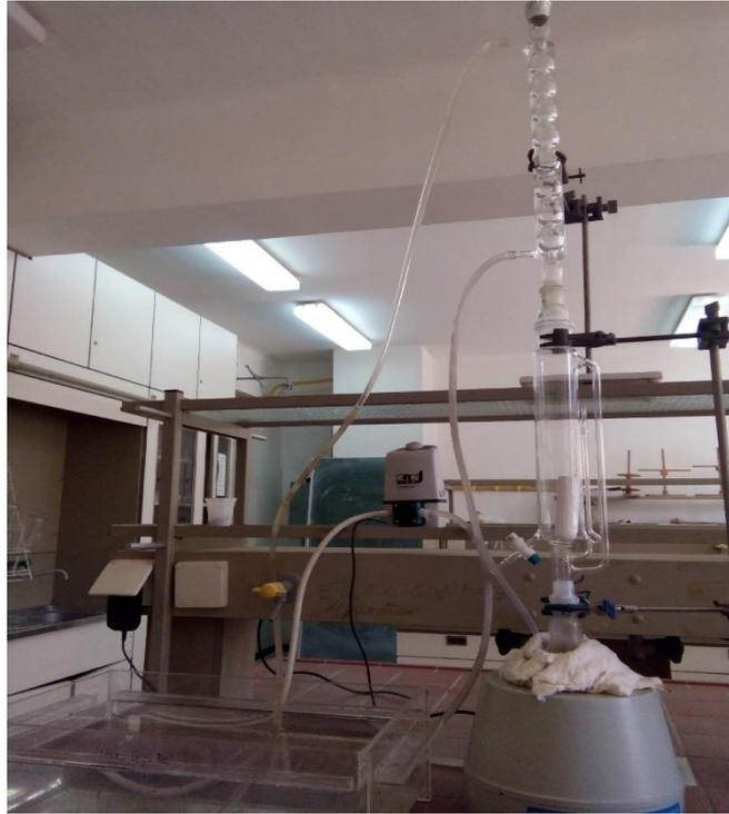
**Figure II.3:**Photo montrant le montage de l'extracteur de soxhlet.
