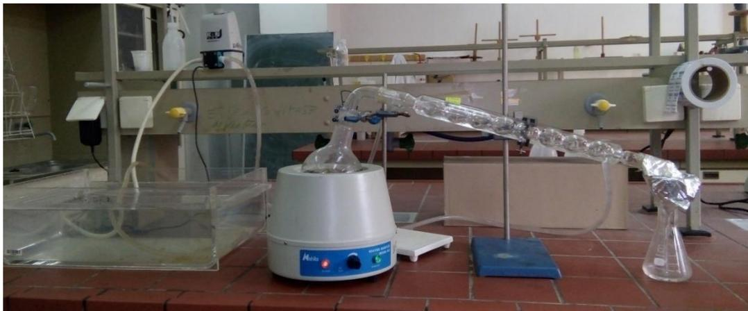
**Figure II.4:** dispositif de distillation.
