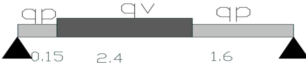
**Figure III.6 :** Schéma statique de l’escalier d’habitation.
