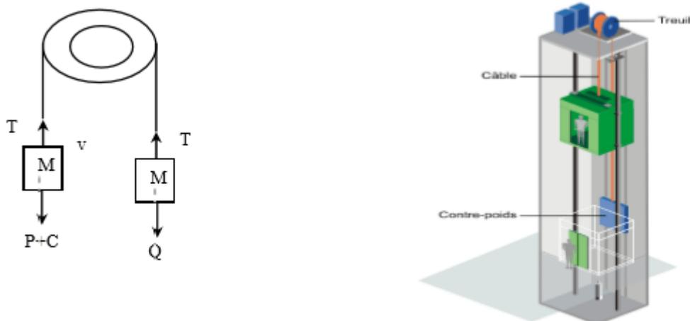
Figure3-15 : schémas statique et concept de l'ascenseur
