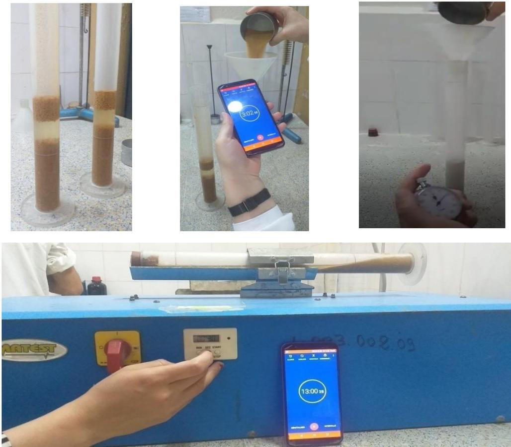
**Figure II.10.:** Détermination de l'équivalent des sables.
