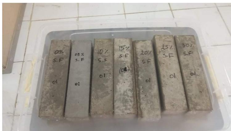
Figure III.17 : Les éprouvettes de mortiers conservées dans l'eau
