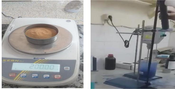
**Figure II.11:** Essai au bleu de méthylène.
