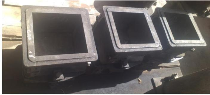
**Figure III.2:** Les moules 15×15×15 cm<sup>3</sup>
