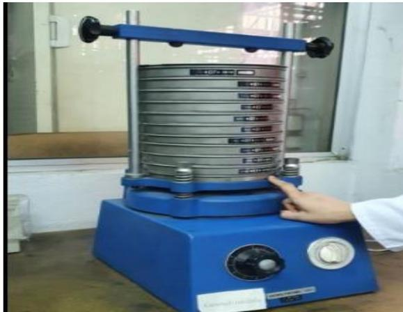
**Figure I.8:** machine de test de granulométrie
