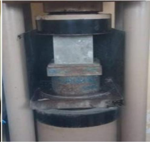
**Figure III.26:** Essai de compression sur béton
