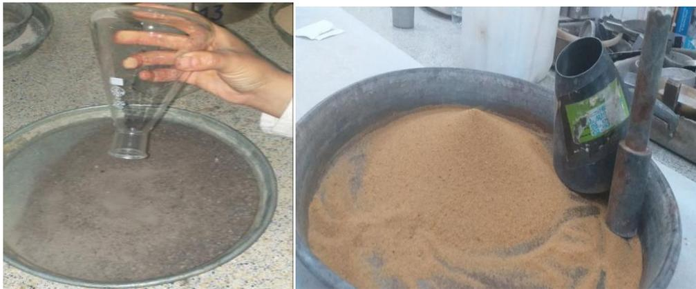
Figure II.15: Détermination de la masse volumique absolue.
