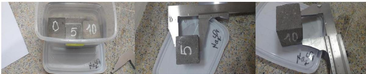
**Figure IV.13:** Mortiers conservés dans une solution sulfatique
