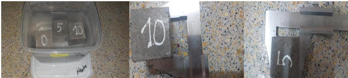
**Figure IV.14:** Mortiers conservés dans une solution basique
