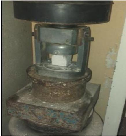
**Figure III.25:** Essai de compression sur mortier
