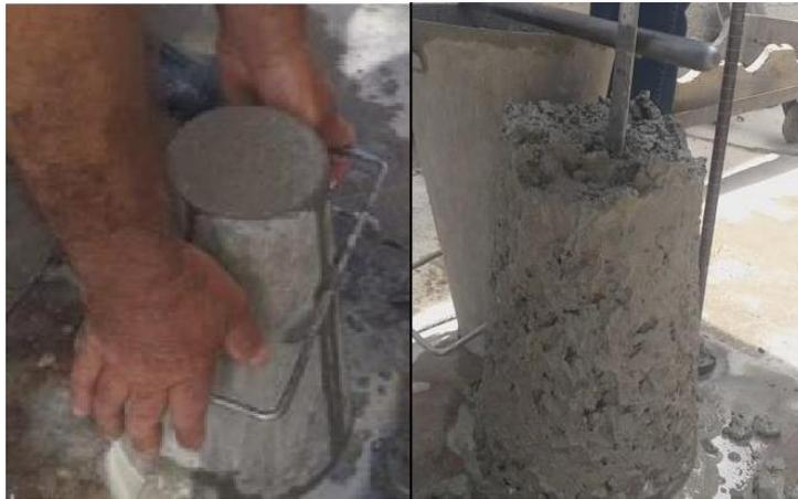
**Figure III.20** : Essai d'affaissement
