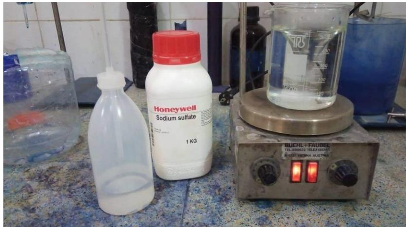
**Figure III.28 :** Préparation de la solution de 5% de  $\text{Na}_2\text{SO}_4$ .
