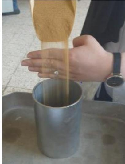
**Figure II.18.:** Coulage du matériau.
