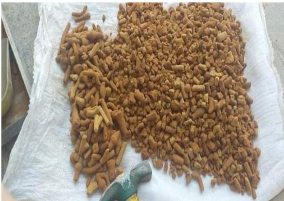
**Figure II.5.:** Noyau de sable avant concassage
