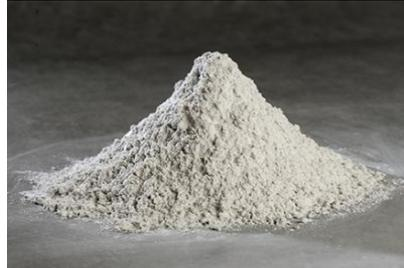
**Figure I.3:** Laitier de haut fourneau
