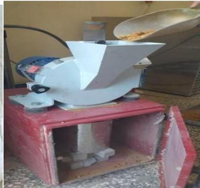
**Figure II.6.:** Broyeur
