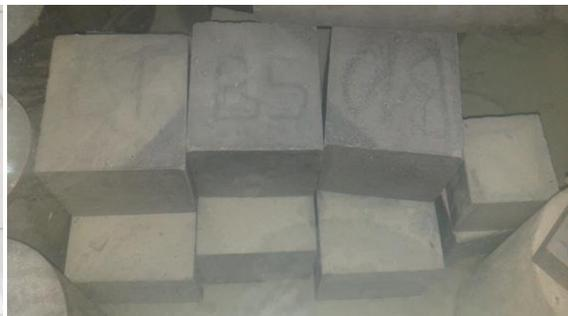
Figure III.23 : Conservation des bétons
