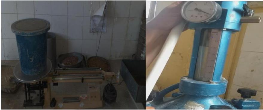
Figure IV.2 : Détermination de la quantité d'air occlus.
