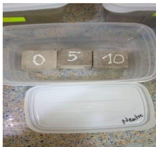
**Figure III.30 :** Les éprouvettes dans un milieu neutre.
