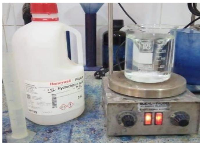
**Figure III.27 :** Préparation de la solution de 5% de HCL.
