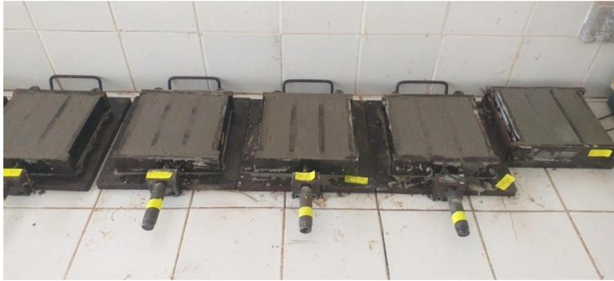
Figure III.15 : Les éprouvettes de mortier.
