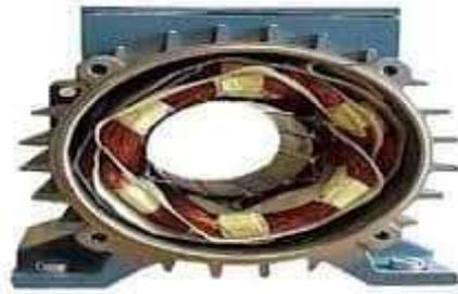
Fig.2 Stator d'une machine asynchrone
