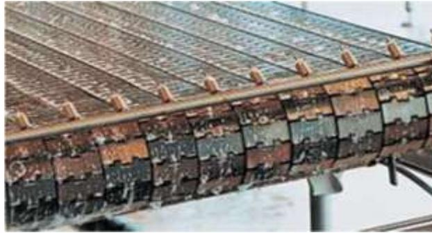
Fig.11 Chaîne de convoyeur à chaîne avec charnière en acier [4]
