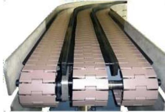
Fig.1 Convoyeur à Chaîne [1]
