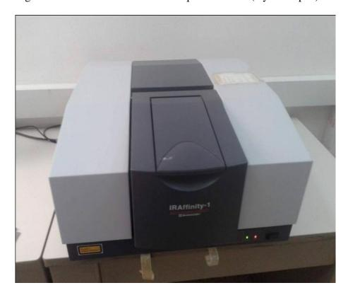
Figure II.3: Spectroscopie infrarouge (IR-TF).
