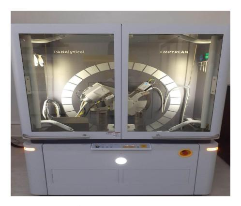
Figure II.2: Diffractomètre (DRX).
