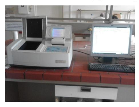
Figure II.1: spectrophotométrie UV-visible.
