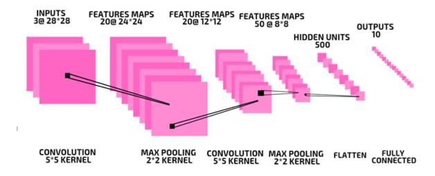
Figure II. 4: l'architecture du réseau convolutifLeNet
