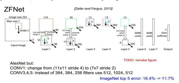
Figure II. 6 : l'architecture du réseau convolutifZFNet
