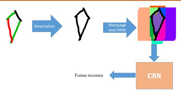
Figure III. 5 : Schéma générale de notre système
