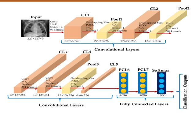
Figure II. 5 : l'architecture du réseau convolutifAlexNet
