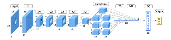
Figure II. 7 : l'architecture du réseau convolutifGoogleNet
