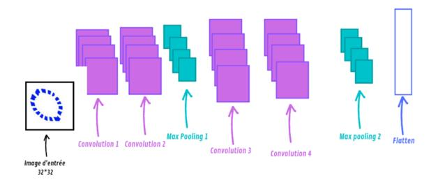
Figure III. 10 : Architecture de modèle à 4 couches
