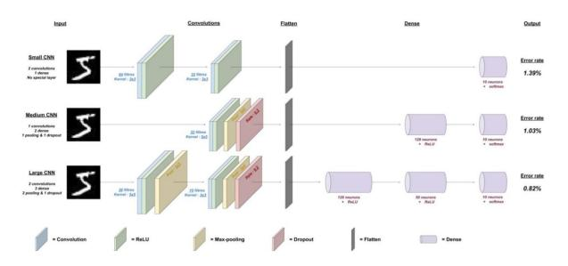
Figure II. 9: Architecture d'un réseau CNN
