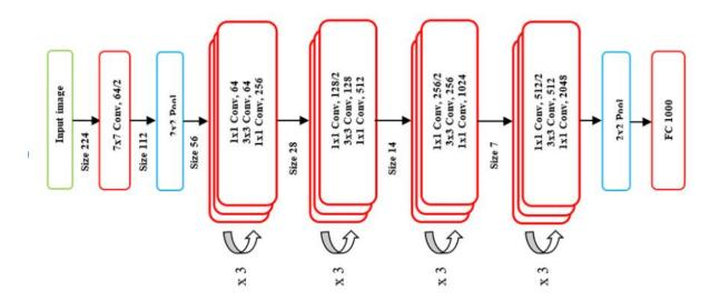
Figure II. 8 : l'architecture du réseau convolutifResNet
