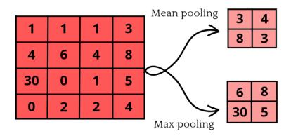
Figure II. 12: illustration de l'opération de pooling
