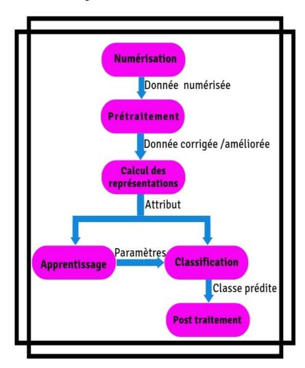
Figure I. 1 : Schéma général d'un système de reconnaissance des formes
