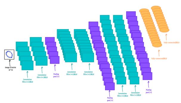
Figure III.12 : Architecture de modèle à 6 couches
