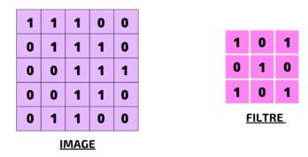
Figure II. 10 : Exemple simpliste des valeurs des pixels d'une image 5x5 et de valeurs d'une matrice utilisée comme filtre
