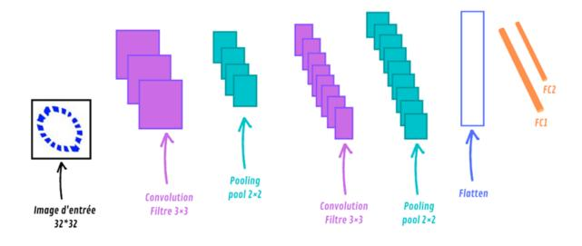
Figure III. 8 : Architecture de modèle à 2 couches
