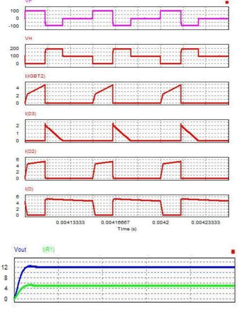
Figure II. 5 : formes d'onde en régime permanent d'une alimentation FORWARD
