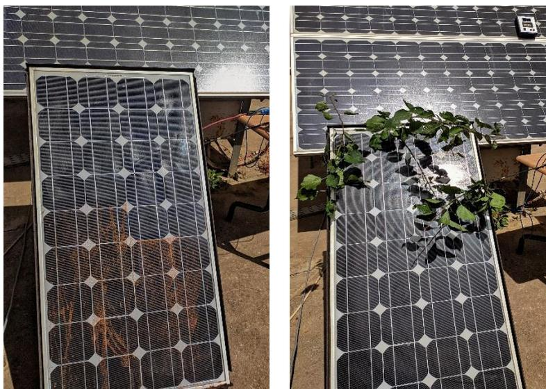
**Figure II-18** Différents types d'ombrages appliqués ( Sable à gauche / Feuilles d'arbres à droite).
