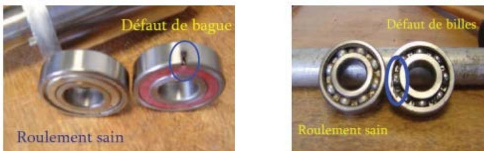
Figure I.11, Vue des roulements sains et défectueux [19].
