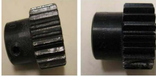
Figure I.15 : Défauts d'engrenages [29]
