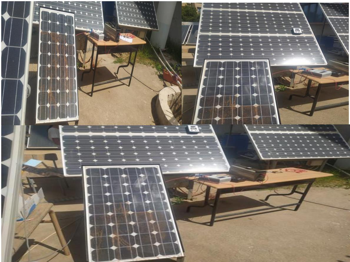
Figure II.7 : Test avec du sable 75% ,50% et 20% d'ombrage
