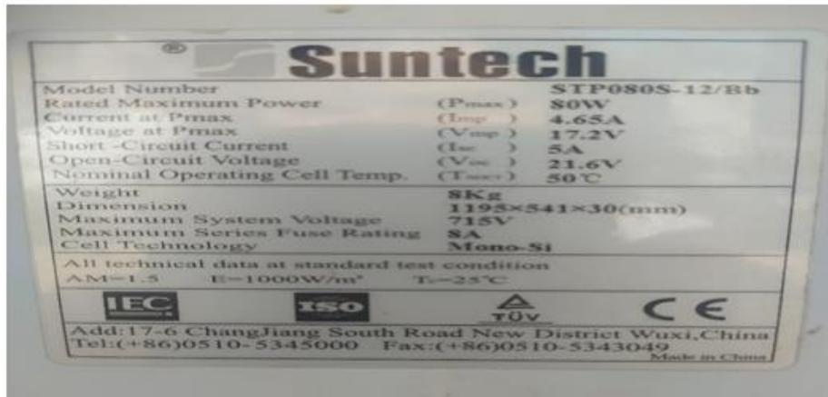
**Figure II.2 : Plaque signalétique de panneau photovoltaïque**
