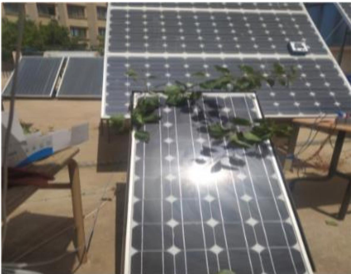
**Figure II.10 : Test d'ombrage avec des feuilles d'arbre**
