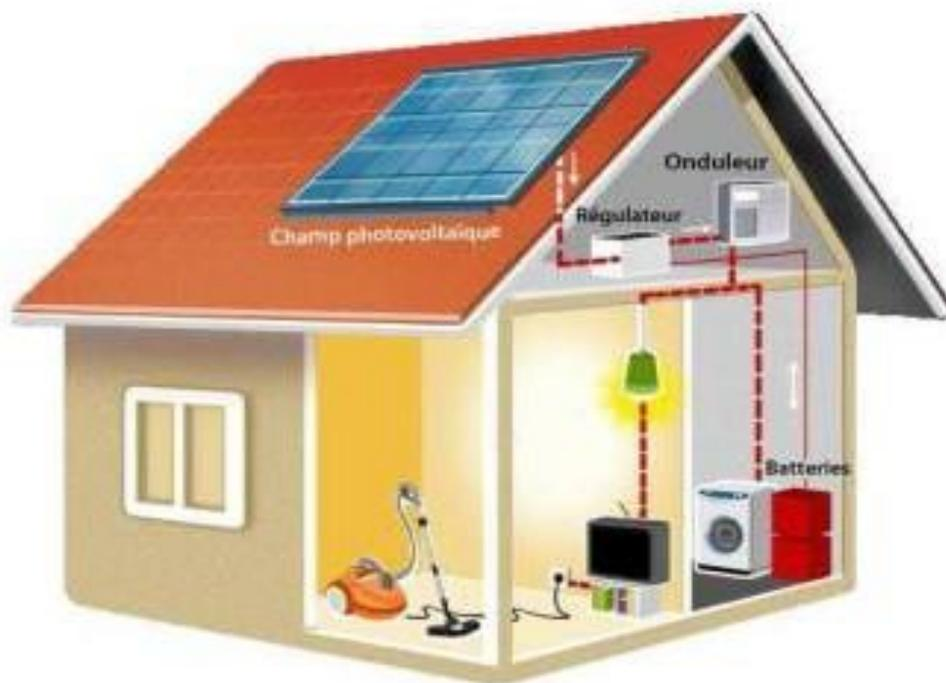
**Figure II. 2:** Structure d'un système PV autonome
