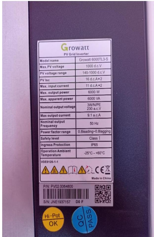
Figure III. 10: Onduleur Growatt 6000W
