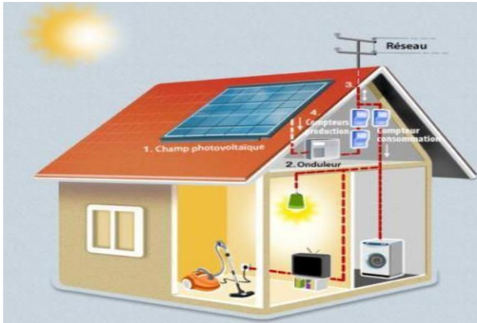
**Figure II. 4:** Structure d'un système photovoltaïque connecté au réseau
