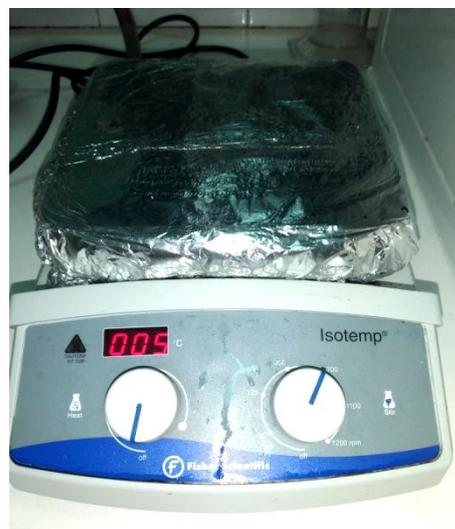
**Figure 8: Agitateur magnétique**
