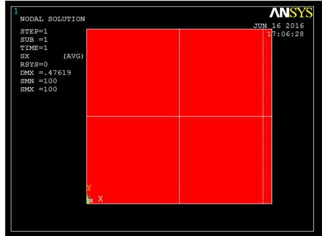
Figure V.11 : Déplacements (mm) et contraintes (MPa) de la plaque pour un maillage (2x2), ( $v = 0$ ) avec ANSYS.
