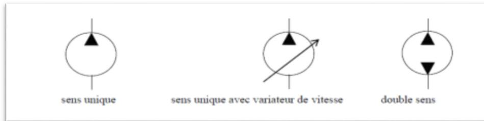
Figure VI-3. Symbole de la pompe hydraulique.
