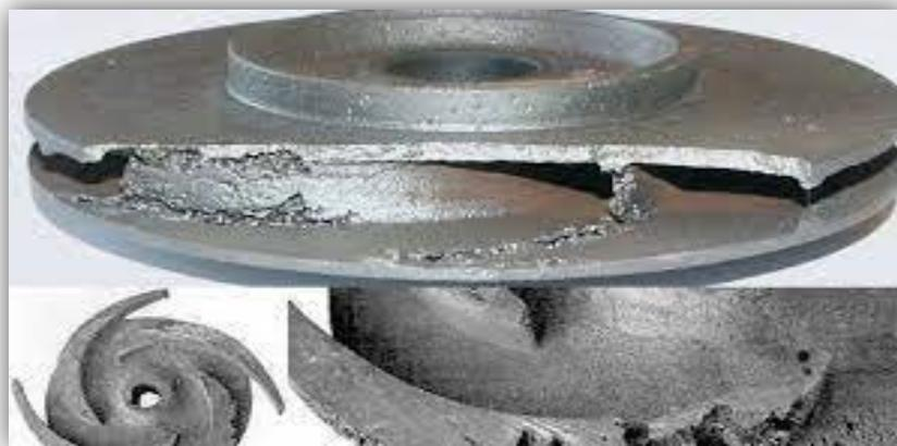
**Figure VI-13.** Photo illustrant le phénomène de cavitation sur les aubes d'une pompe centrifuge.
