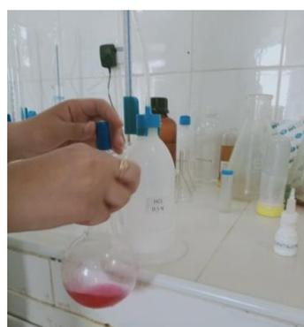
Titration de la solution avec l'acide chlorhydrique
