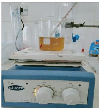
Chauffage jusqu'à 40°C
