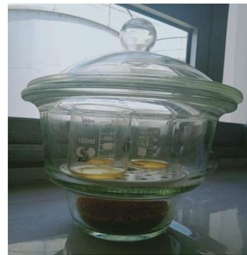
Mettre l'échantillon dans un dessiccateur pour compléter le séchage.
