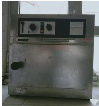
Séchage de l'échantillon dans l'étuve à 103°C pendant 1 à 2h
