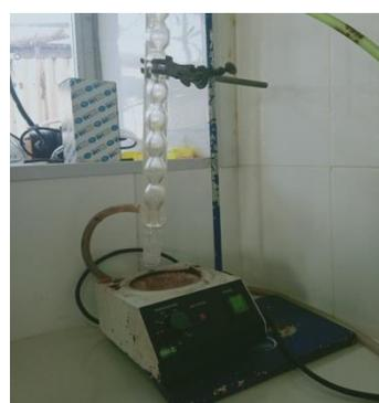
Chauffe ballon surmonté d'un réfrigérant à reflux
