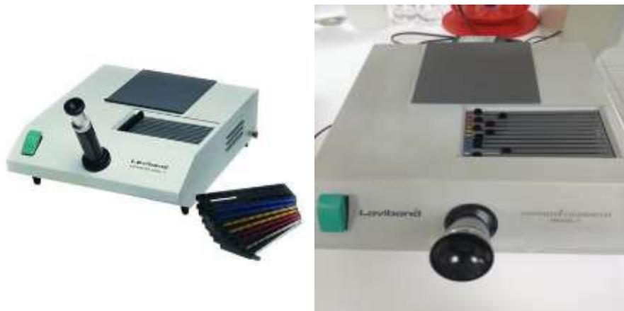
**Figure 9:** Appareil calorimètre Lovibond.
