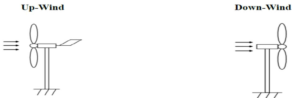
Figure 3: Turbines éoliennes en amont et en aval.
