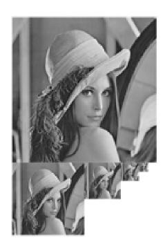
FIGURE 2.3 – L'image d'entrée est redimensionnée à différentes échelles pour construire une pyramide d'images
