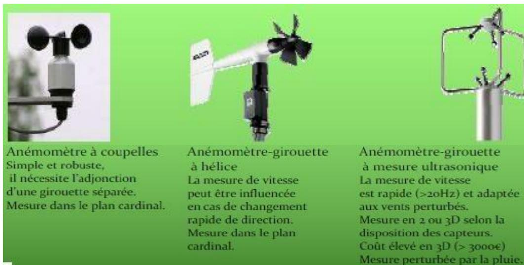
Figure II.2 : Divers types d'anémomètres
