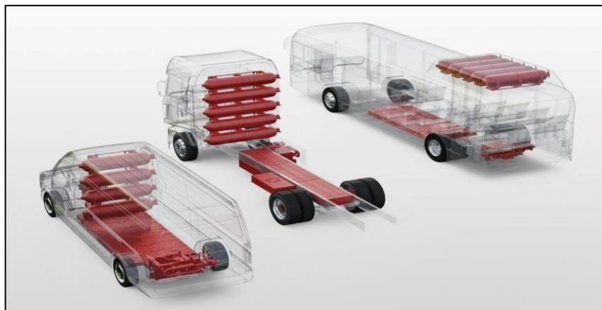
**Figure 5.2 :** Disposition des PAC et réservoirs dans des véhicules utilitaires
