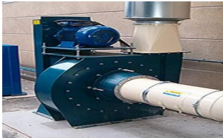
**Fig. I. 12 :** Ventilateur pneumatique
