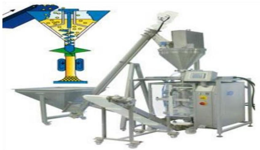
**Fig. III. 6 :** Système d'alimentation et de dosage par vis sans fin
