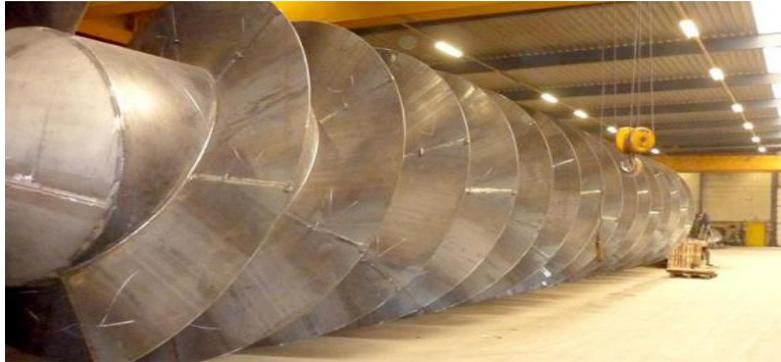
**Fig. III. 8 :** Vis d'Archimède avec âme
