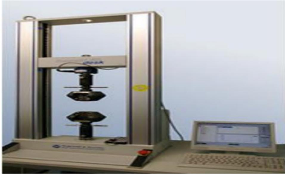
**Figure 13:** Machine d'essai de traction [12]
