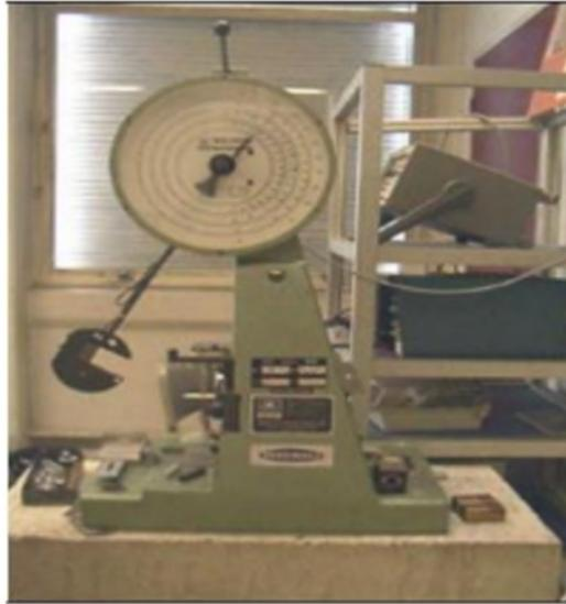
**Figure 23:** Une machine de Charpy [9].
