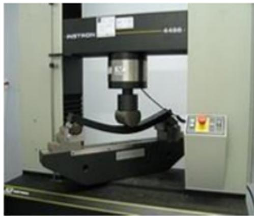
**Figure 25:** Essai de flexion « trois points » d'une poutre [12].
