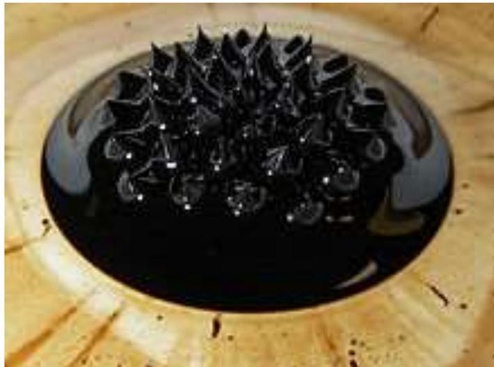
**Figure I.1** : Représentation d'un ferrofluide[5]
