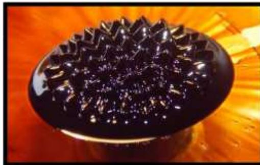
**Figure XI.11 :** Les piques des ferrofluide[5]
