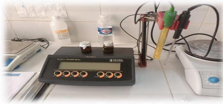
Figure 4 : Appareil multi paramètres de type HANNA,HI2211
