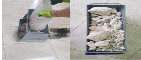
Figure III.3 : versement de l'échantillon sur une série des tamis.
