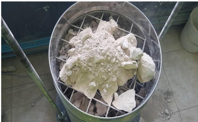
**Figure III.3 :** versement de l'échantillon sur une série des tamis.
