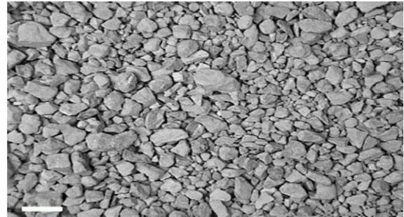
**Figure I.5 :** Figure illustrative de l'uniformité de granulométrie pour n=1.5
