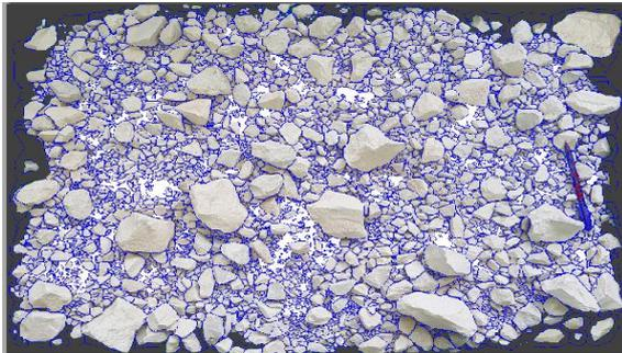
**Figure III.10 :** Graphe de résultat de la segmentation manuel d'originale par Wipfrag.
