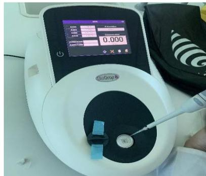
**Figure 23** : Spectrophotomètre à microvolumes BioDrop Duo+.
