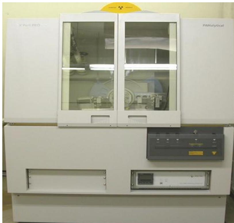
Figure III.15 : Appareil de DRX labo GP
