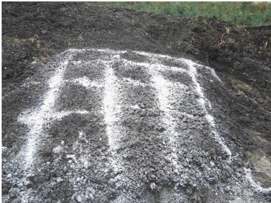
**Figure III.2** : Prélèvement de la boue au niveau de la STEP SAL
