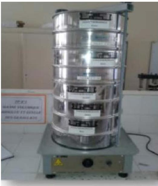
Figure III.7: photo des tamis, labo GP
