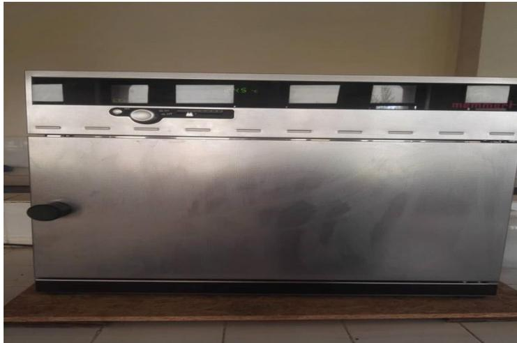
Figure III.3 : étuve de séchage labo 24
